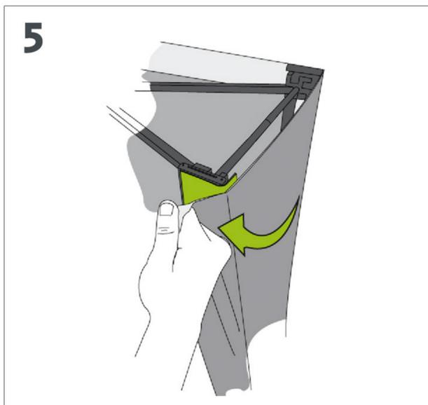
**5** **Accrochez le visuel sur l'arrière pour bien le tendre. Attention à bien le décrocher à l'arrière avant de replier la structure.**
