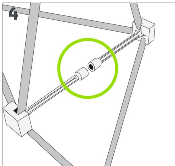
**4** **Les connecteurs magnétiques puissants permettent à la structure une fermeture automatique en quelques secondes.**
