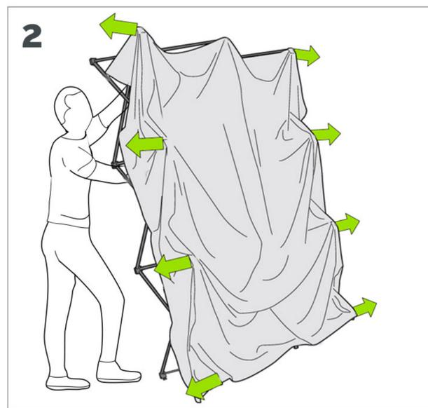
**2** **Déployez la structure en la penchant légèrement vers l'arrière.**
